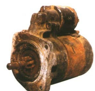
DÍL JE SILNĚ ZKORODOVANÝ
